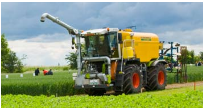
Die Dosieranlage der agrotop GmbH für PIADIN®.
